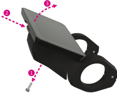
1. Falls die Diebstahlsicherungsschraube montiert ist, Diebstahlsicherungsschraube entfernen.
